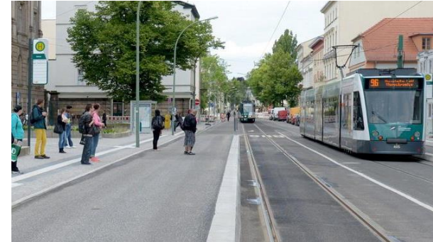
Ausführungsbeispiel einer befahrbaren Kap-Haltestelle auf der Fahrbahn in Potsdam (Quelle: Bernd Gartenschläger)
